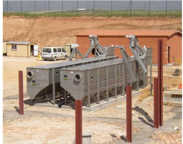
O líquido que atravessa a malha entra numa tremonha onde, otimizada pela introdução de ar, se produz a sedimentação da areia existente. Um parafuso horizontal, que trabalha em sensu contrário ao fluxo e fica no fundo do depósito, encarrega-se do transporte das areias até o depósito desde onde um parafuso classificador inclinado extrai as areias e as desidrata e descarrega no contentor só preparado ao fim.
